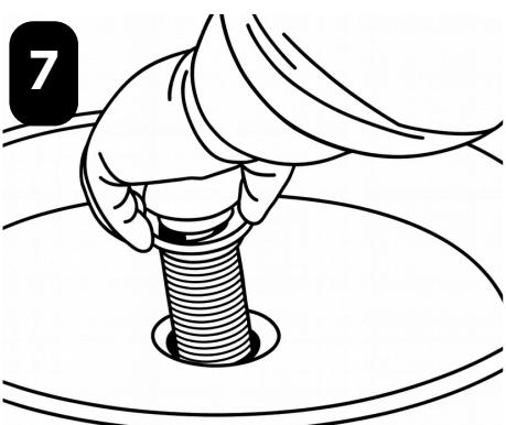
FILL DRAIN AREA WITH PLUMBERS PUTTY, SURROUNDING DRAIN RIM
