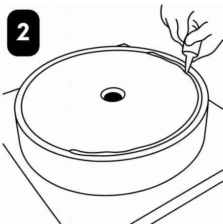
RUN A LINE OF CLEAR BATHROOM SILICONE AROUND THE UNDERSIDE OF THE SINK 1/2" BACK FROM THE EDGE
